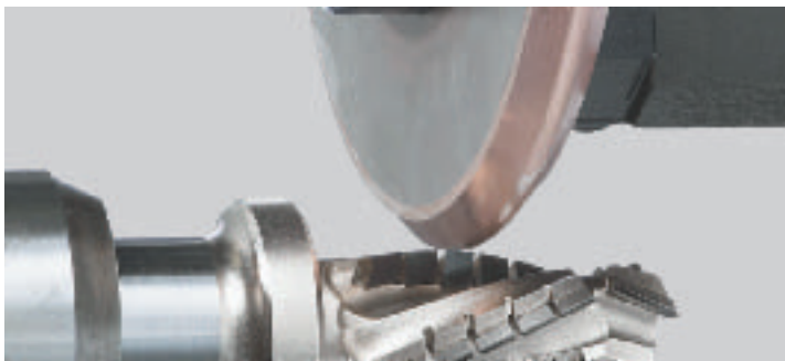
Fresa de mango con múltiples cortes y a cortas distancias (Fresa Speedy)
