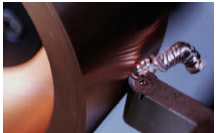
Rectificación del disco de erosión de la máquina
